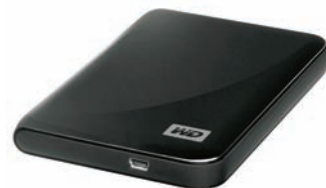
OBR. 2 „Malý“ (2,5palcový) externí pevný disk, napájený přes USB.
