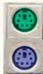
► Obr. 3. Zelený port PS/2 je určen pro myš, modrofialový zase pro klávesnici.
